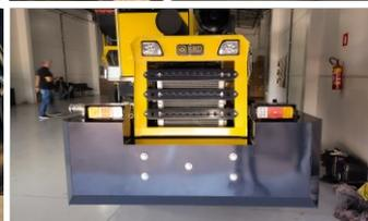
O equipamento K150 da KRD, conta com uma nova cabine remodelada na parte central ROPS/FOPS, com câmeras Full HD, porta com abertura Lateral, ar condicionado. Sistema de pesagem eletrônico de carga, com sensor de pressão hidráulico, acompanha um display e impressora de relatório do traço de concreto.
